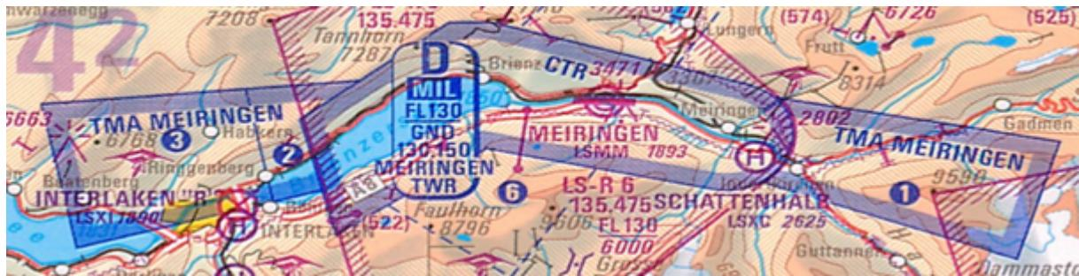
Das in der Mitte ist immer die Basis Nr.1 und Nr.3 sind wo die Flugschneisen sind- je nach Höhe fliegen und landen dort Flugzeuge. In Locarno z.B., wenn Laserflüge sind, kommen wir in eine CTR Zone da die Flughöhe  $\geq 130\text{FLf}$  ist (Bergkette)
